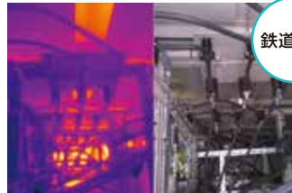
変電設備等の発熱異常検知
