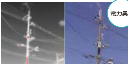
電柱等の熱源検知
